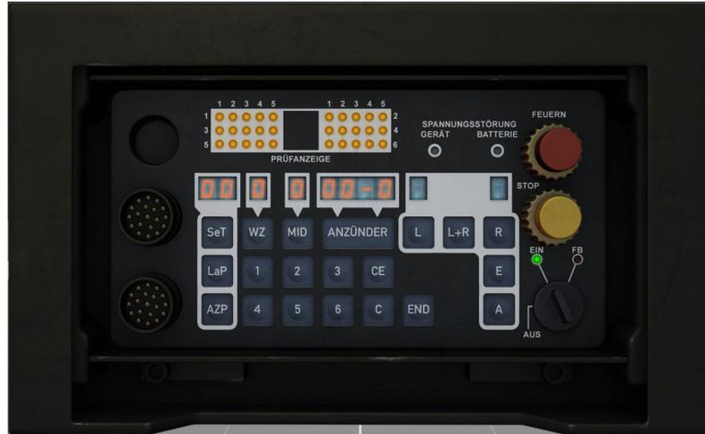
Das Einstell-, Prüf- und Abfeuergerät (EPAG) wird über das Mausradmenü des Kommandanten geöffnet. Für den Start der Programmierung wird der Drehschalter (schwarz, rechts unten) mit Klick auf die rechte Maustaste auf **EIN** gestellt.
