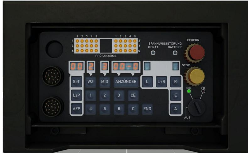
Zunächst wird die Wirkzeit der Mine über den Schalter **WZ** mit anschließender Eingabe einer beliebigen Zahl eingestellt. Die Wirkzeit wird nicht simuliert. Danach erfolgt die Eingabe der Minenverlegedichte über den Knopf **MID**. Diese bestimmt im automatischen Modus die Distanz zwischen den einzelnen Feuerstößen. Auf nachfolgender Seite (4) findet sich eine Tabelle mit den Distanzen zwischen den Feuerstößen.
