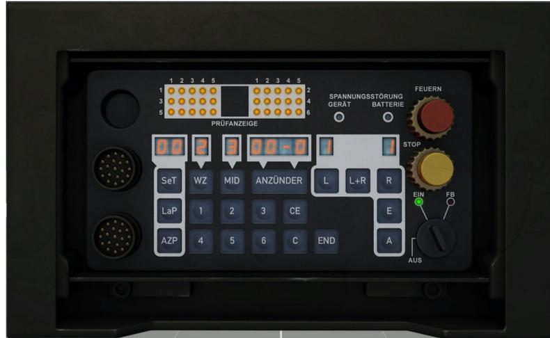
Nach Eingabe der Wirkzeit und der Minenverlegedichte wird festgelegt, von welcher Seite Minen verschossen werden. Dabei können die Werfer beidseitig (Taste **L+R**), die linksseitigen Werfer (Taste **L**) oder die rechtsseitigen Werfer (Taste **R**) gewählt werden.
