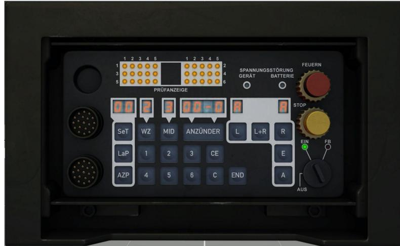
Nach Eingabe der Seite wird abschließend der Feuermodus eingestellt. Um die vorher eingestellten Parameter des Ausstoßes zu nutzen, wird der automatische Modus mit der Taste **A** aktiviert. Falls die Minen manuell ausgeworfen werden sollen, kann dies über die Taste **E** festgelegt werden. Nach Eingabe sämtlicher Parameter wird der Drehschalter mit erneutem Klick auf die rechte Maustaste auf feuerbereit (**FB**) gestellt.
